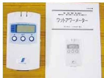
ワットアワーメーター 消費電力や二酸化炭素排出量の測定
